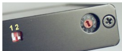
Abbildung 3 DIP-Schalter und Drehschalter.
