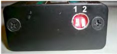
**Abbildung 3** DIP-Schalter und Zündkurvenauswahl.
