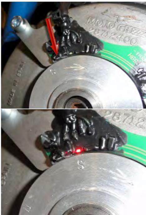
**Abbildung 4** Ausrichten der Magnetscheibe so daß die LED gerade an- bzw. ausgeht.
