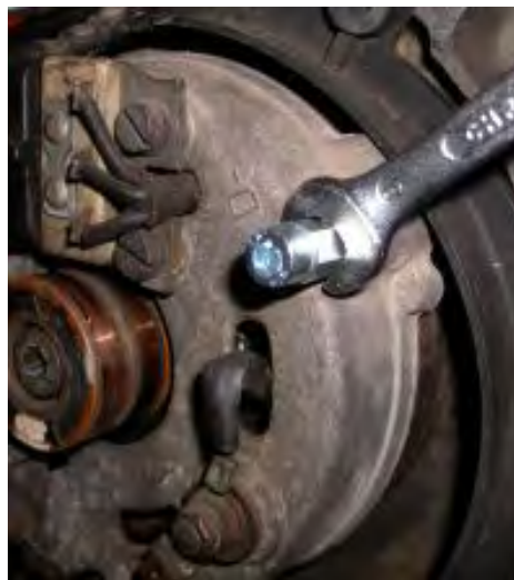
Montieren des Sechskantes auf den Gewindestangen
